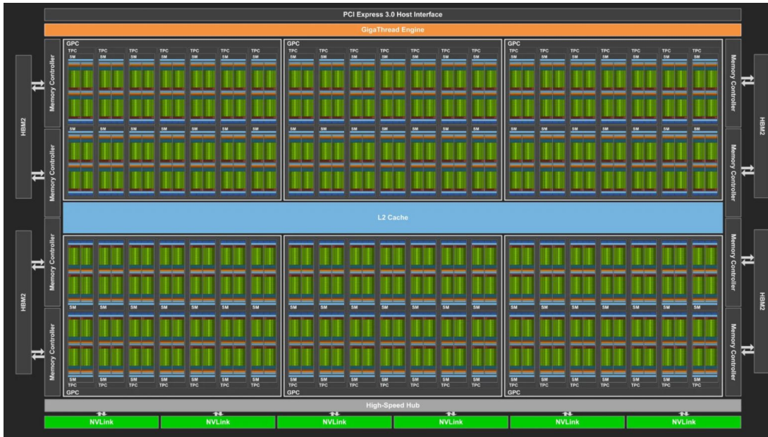
Figura 4.1: Chip GV100 de la arquitectura Volta
