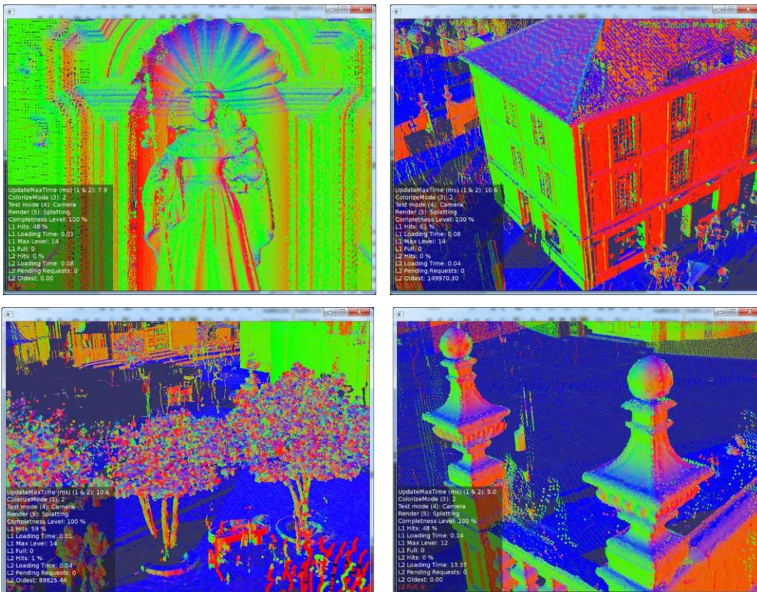
Ilustración 54. Inspección visual de la aproximación de las normales de los puntos.
