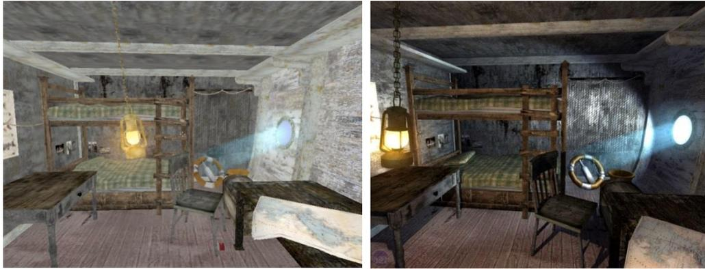
Ilustración 10. Diferencia de calidad entre un render con el clásico pipeline fijo tipo T&L (izquierda) y otro utilizando un pipeline programable con vertex y fragment shaders (derecha) (Fuente: [electriccartilage.files.wordpress.com](http://electriccartilage.files.wordpress.com))
